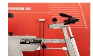
Lenkerhöhe elektronisch einstellbar. Oberrohr- und Vorbaulänge mechanisch einstellbar. Handlebar height electronically adjustable. Top tube and stem length mechanically adjustable.
