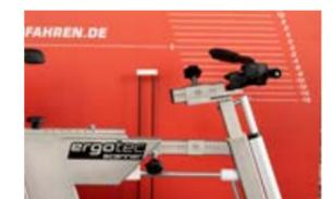
Lenkerhöhe elektronisch einstellbar. Oberrohr- und Vorbaulänge mechanisch einstellbar.
